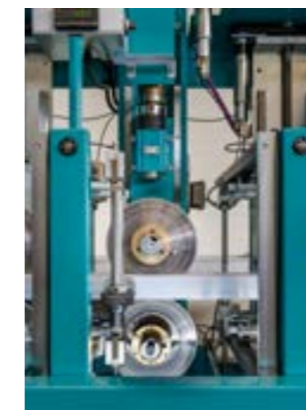
Maschine zum Einpressen der wärmegeprägten Profile
