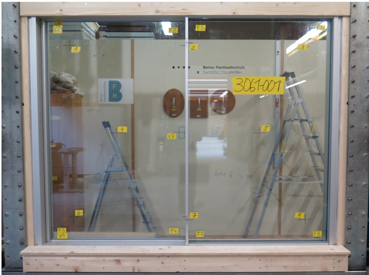
Image 5: Élément d'essai 1, vue de la face d'attaque, position des points testés, charge dynamique
