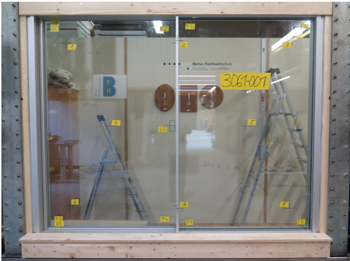
Image 6: Élément d'essai 1, vue de la face d'attaque, position des points testés, essais manuels
