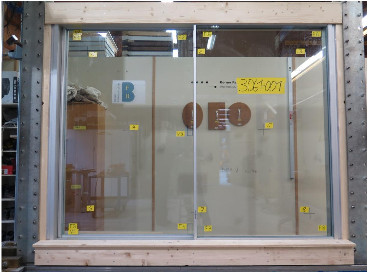
Image 2: Élément d'essai 1, vue de la face d'attaque, position des points testés, charge statique.
