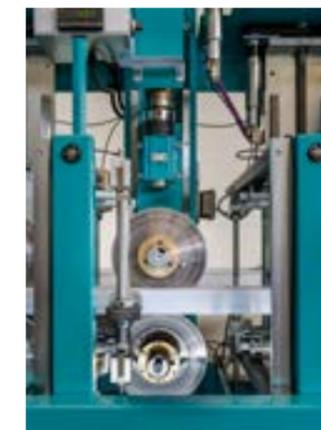
Maschine zum Einpressen der wärmegeprägten Profile
