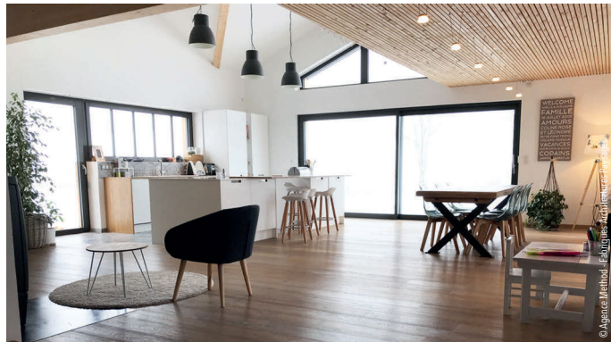
Minco a élaboré de nombreuses baies à levage qui offrent la possibilité de grandes largeurs en restant en deux vantaux. Le levage coulissant permet un apport lumineux important tout en étant très performant sur le plan thermique
